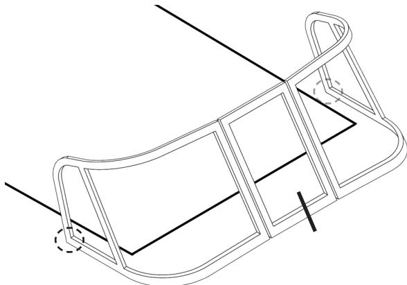
Для точного позиционирования ветрового стекла на лодке необходимо установить боковые элементы на точках отмеченных ранее. Боковой элемент рамки должен располагаться примерно параллельно друг другу и комингасам, а центр калитки должна находиться на одной оси с центром носовой палубы.
