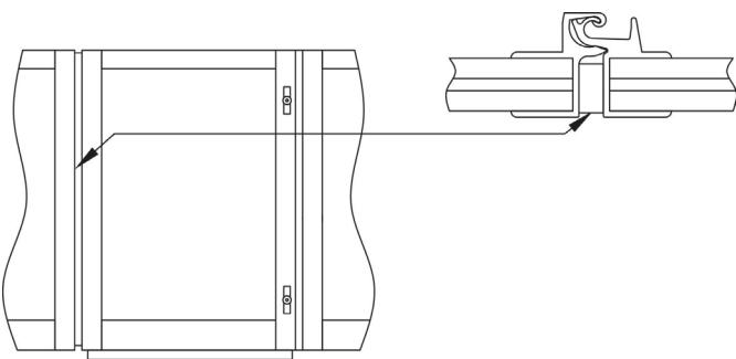
Наклеиваем уплотнитель 8x17 в проём калитки.
