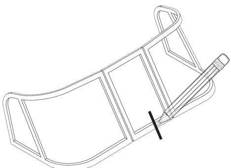
Для дальнейшего, точного, позиционирования ветрового стекла относительно оси симметрии лодки, необходимо отметить центр палубы в районе выхода (калитки).
