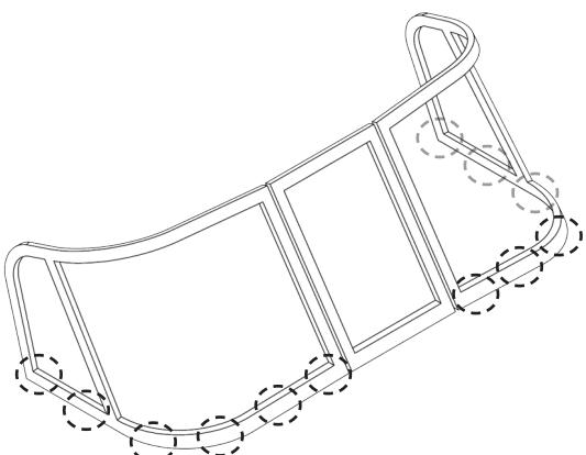
В нижнем профиле рамки есть отверстия, через которые будет осуществляться крепление ветрового стекла к корпусу лодки. В случае если по какой-то причине вы не можете использовать данные отверстия, необходимо самостоятельно просверлить профиль рамки в ближайшем доступном месте используя для этого сверло диаметром 4,8-5 мм.
