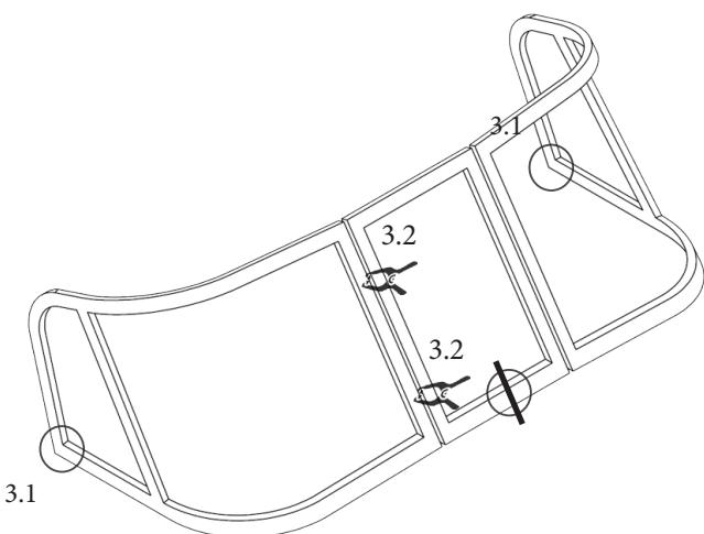
3.1 Зафиксируйте створ калитки при помощи струбцин или зажимов обеспечив зазор 3 мм в притворе.
